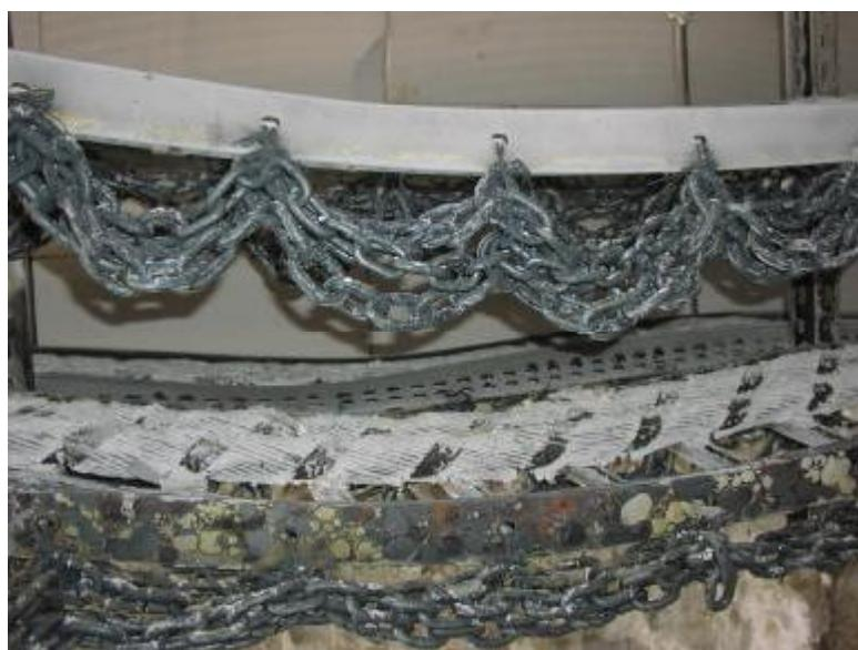
**Badanie systemów tras kablowych wg normy DIN 4102-12
