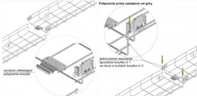
Szttywne, mocne połączenie KLIK dwóch korytek KDSZ...
