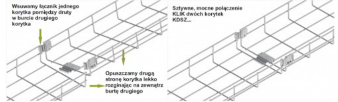
Sposób montażu korytek KDSZ nr 1
