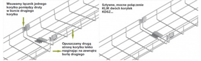
Sposób montażu korytek KDSZ nr 1
