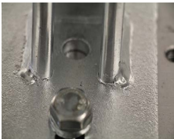
Zdjęcie 31: Kierunek poprzeczny testu 1a, 50 kg / m, po powtórzeniu z trzęsieniem ziemi 200% (-3 dB), pierwsze pęknięcie w spoinie.
