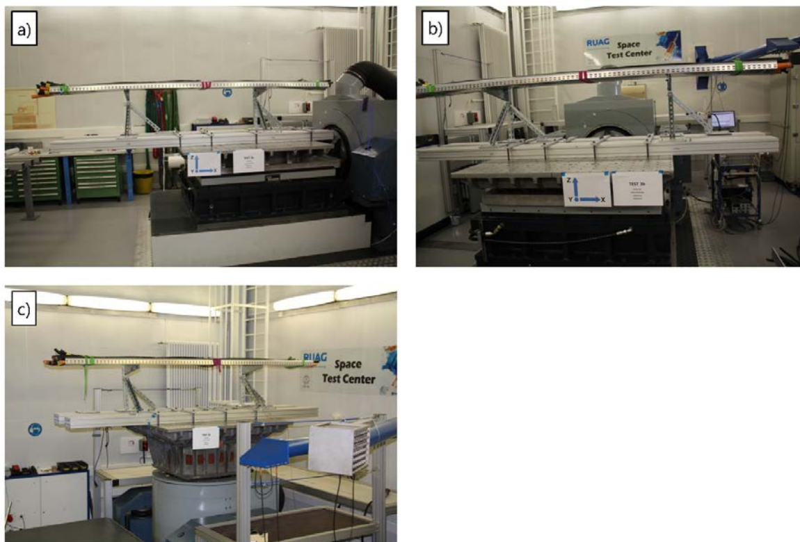
Ilustracja 28: Stół vibracyjny, - test 3a: a) wzdłużny, b) poprzeczny, c) pionowy
