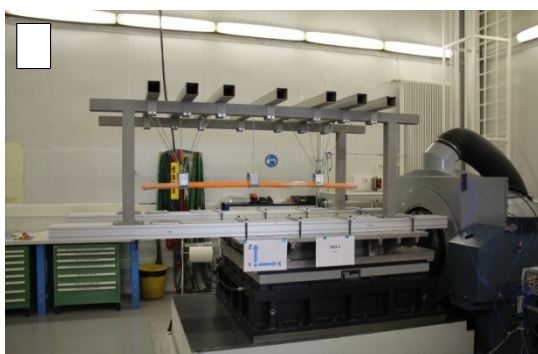
Ilustracja 35: Próba 4: a) konstrukcja składająca się z dwóch obejm z odciągami i jednej swobodnie zawieszonej bez zacisku, b) czujnika przyspieszenia na obejmie zaciskany
