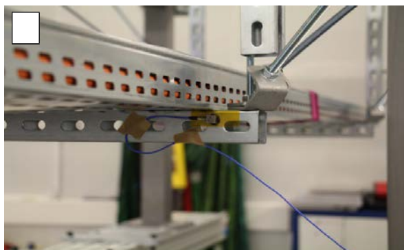
Rysunek 36: Test 6: a) Konstrukcja, b) Czujnik przyspieszenia na trawersie
