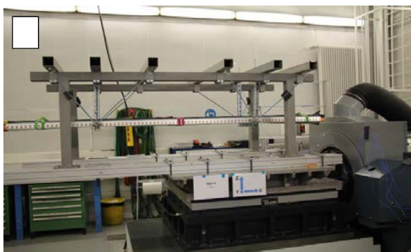
Rysunek 36: Test 6: a) Konstrukcja, b) Czujnik przyspieszenia na trawersie
