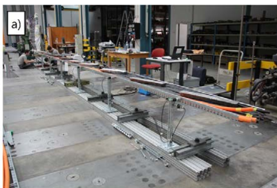
Zdjęcia 12: Analiza częstotliwości konstrukcji długich: a) Test 2a, b) Połączenie pomiędzy korytkami kablowymi
